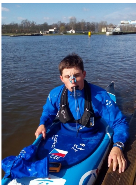
Obrázek č. 6: Kajakář napojený na přístroj Cortex Metamax 3B, Garmin GPS2 a Polar RS800.
