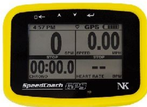
Obrázek č. 3: SpeedCoach GPS2 umožňující sledování okamžité rychlosti.
