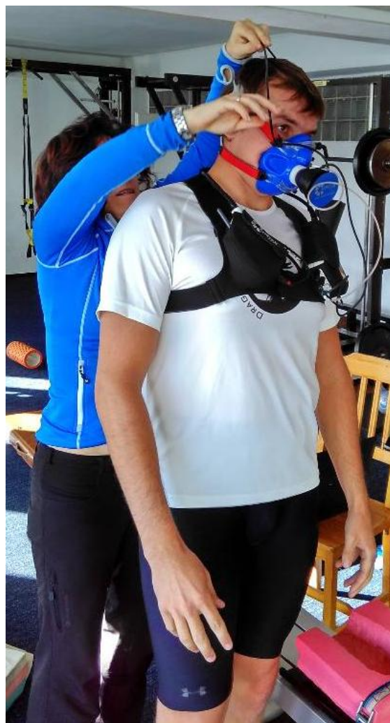
Obr. č. 10: Připevňování přístroje Metamax 3B laborantkou na testovaného kanoistu
