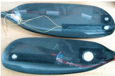
Obrázek 2 Nezakrytý senzor na pádle (Helmer a spol., 2011)
